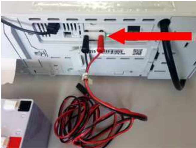
Figura 3 – conectar o cabo Faston, primeiro nos bornes da urna eletrônica – Vermelho com vermelho e preto com preto.
