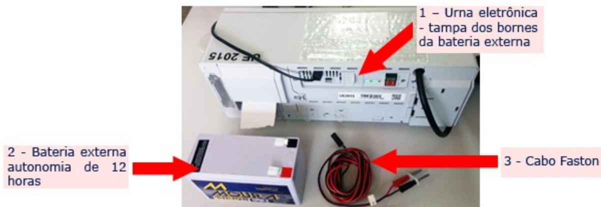
Figura 01 – Kit necessário para instalação da bateria externa
