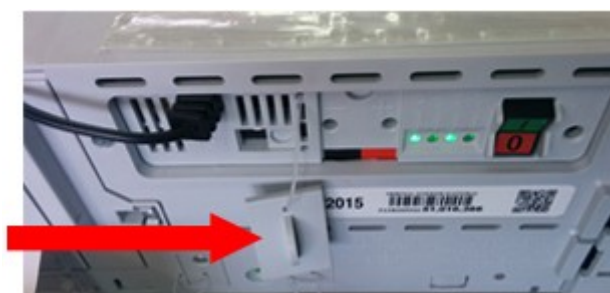
Figura 2 – Retirar a tampa dos bornes da bateria externa
